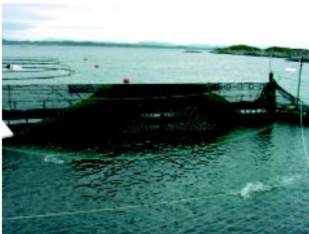
Figur 1 Skifting av grodd not ved hjelp av trommel. Ei ny, rein not vert samtidig tromla ut på motsett side av merden.
