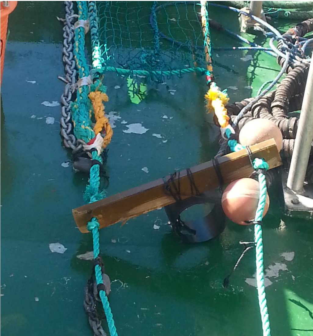
Figur 10: På vingendene brukte vi børtre av tre.
