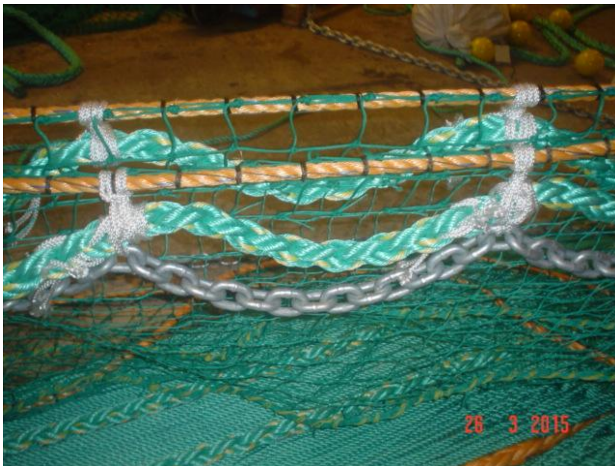
Figur 3: En 38 mm 'sabb' og 13 mm kortlenket kjetting ble montert på grunntelnen.
