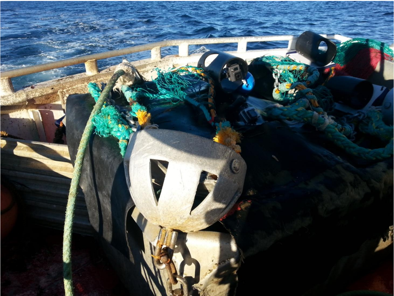
Figur 12: Med halvkuler i aluminium som børtre snurret snurrevadvingene seg.
