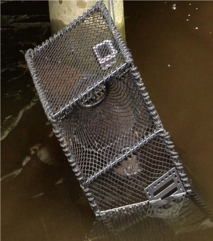
Figur 3. Teine med 70 mm ring i kalv. Hann oteren prøver og presse hodet inn gjennom kalv ringen. Skallen kommer ikke igjennom.
