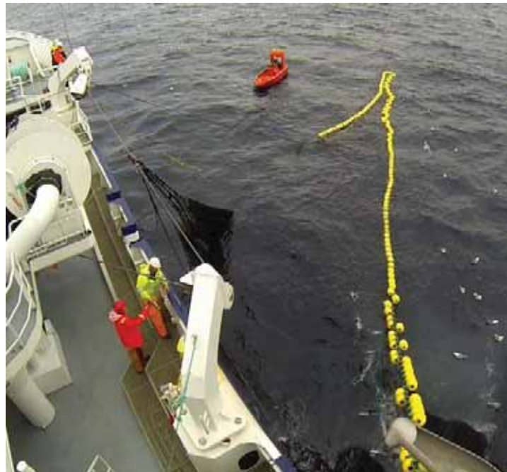
Figur 14. Geila er åpnet for å slippe ut fisk, men blir delvis stengt igjen av en not-fold som strekker seg ut fra den nederste ringen.
