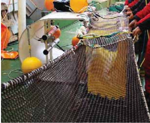
Figur 4. Deep-Vision bestående av en ramme av hvit hardplast for montering av kamera og lys inni og plassert på utsiden av en kanal i trålbelgen laget av kvadratmasker kledd innvendig med gul presenningsmateriale..
